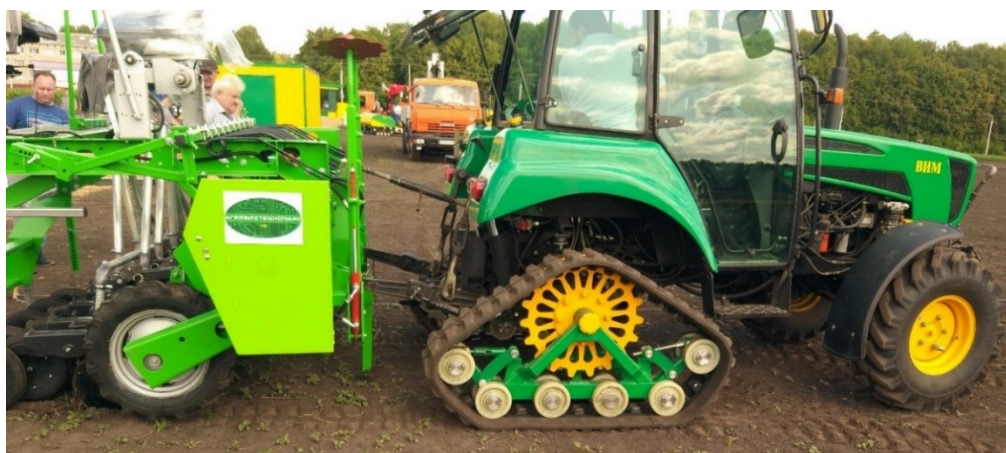
Рис. 4. Опытный образец СГХС на тракторе «Беларус-622» / Fig. 4. Design project of a removable tracked undercarriage system on the “Belarus-622” tractor
