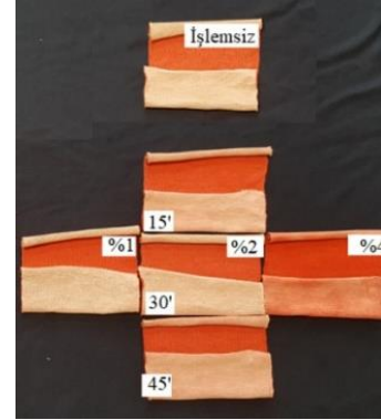
Şekil 4. Farklı koşullarda kitosan ile çektirme yöntemine göre ön işleme tabi tutulmuş ve işlemsiz kumaş numunelerinin 1:2 metal kompleks boyarmadde (Lanaset Red 2B) ile boyama sonrası ön ve arka yüz görünümleri (ön yüz: poliamid, arka yüz: pamuk)
