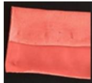
Şekil 8. Kitosan ve çapraz bağlayıcı kullanılarak fulardda yapılan aplikasyon sonrası yün reaktifi ve nüans boyası olarak 1:2 metal kompleks ve pamuk reaktifi kombinasyonu ile boyanmış kumaş numunesinin ön ve arka yüz görüntüleri (ön yüz: poliamid, arka yüz: pamuk)
