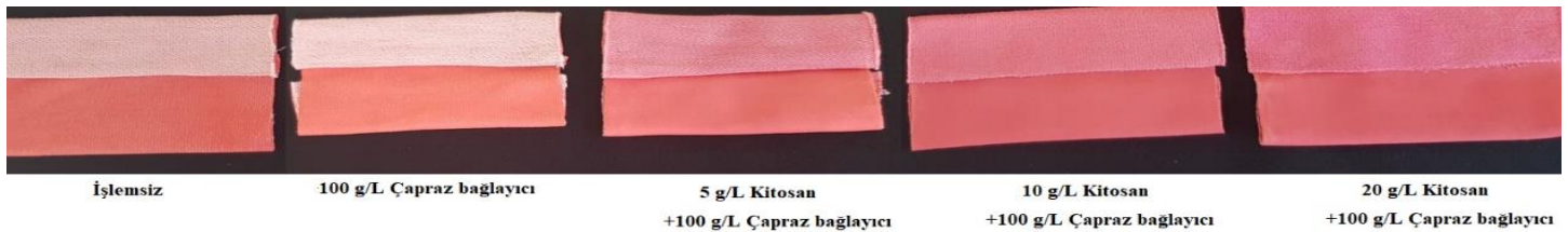
Şekil 6. İşlemsiz, "sadece çapraz bağlayıcı" ve "çapraz bağlayıcı + kitosan" kullanılarak fularlarda yapılan uygulama sonrası yün reaktifleri ile boyanmış kumaş numunelerinin ön ve arka yüz görüntüleri ( ön yüz: poliamid, arka yüz: pamuk)
