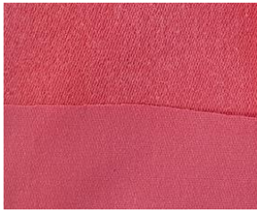
Şekil 9. İşletme koşullarında fulardda kitosan ile katyonikleştirme sonrası tek banyo tek adımlı olarak boyanmış kumaş numunesinin ön (üstte) ve arka (altta) yüz görünüşleri
