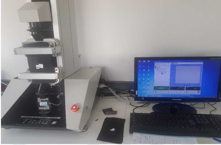
Şekil 3.2. Kopma mukavemetinde kullanılan cihaz ( Orijinal )
