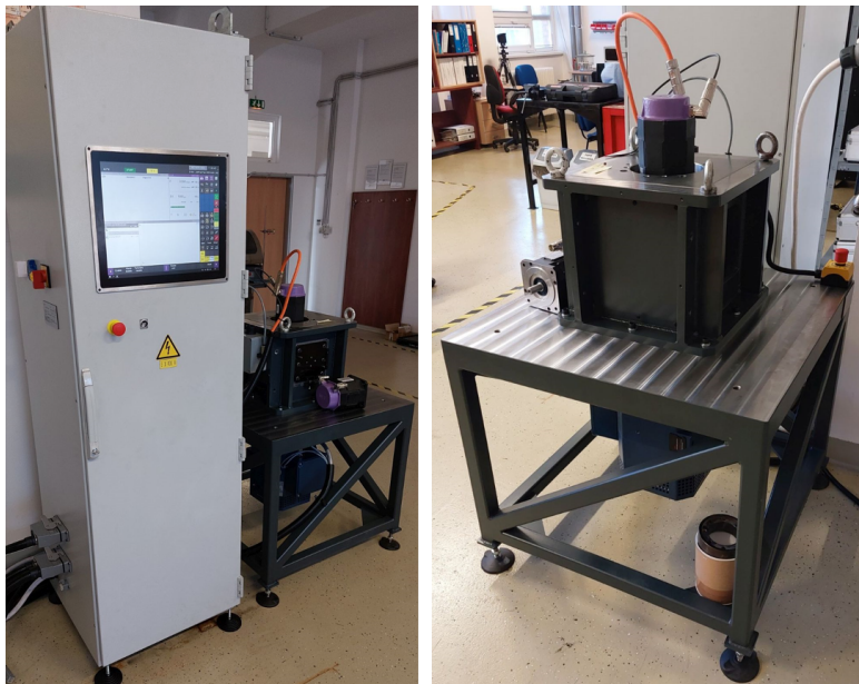
7. ábra. Elkészült és beüzemelt motor fékpad
