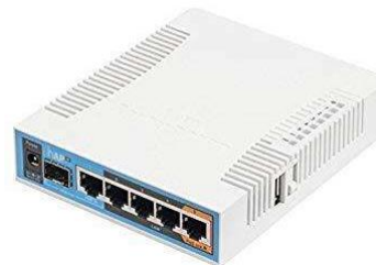
Fig. 2. Mikrotik Access Point
