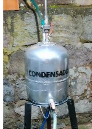
Figura 5. Condensador de gases.
