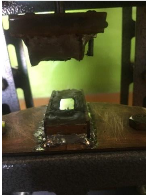
Gambar 3. Konstruksi magnet, piston dan jarak pemasangannya
