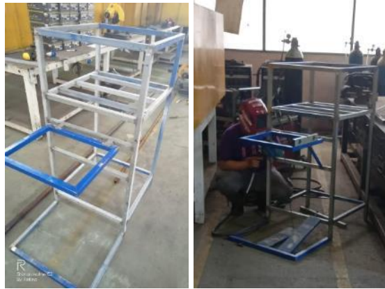
Gambar 7. Proses pengelasan alat cuci tangan
