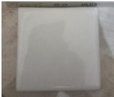
Gambar 6. Keramik dari silica lumpur lapindo yang sudah diekstraksi
