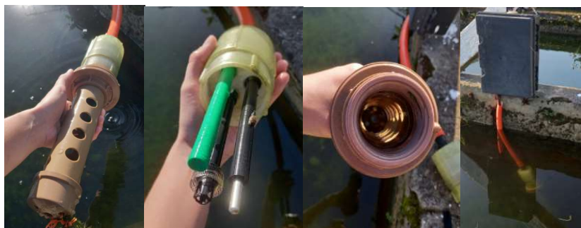
Figura 3. Fotografia de processo de desmonte do equipamento de baixo custo para a proteção de sensores eletrônicos para o monitoramento da qualidade da água.
