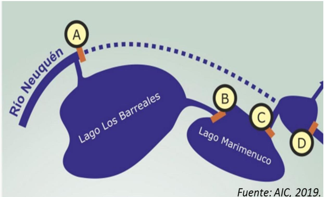
*Figura 3.* Esquema de operación del Complejo Hidroeléctrico Cerros Colorados. La línea punteada indica el antiguo cauce del río Neuquén, tramo regulado entre la Presa Portezuelo Grande y el embalse El Chañar. Los puntos marcados en la imagen corresponden a: Presa Portezuelo Grande (A), Presa Loma de la Lata (B), Central Planicie Banderita (C) y Presa El Chañar (D). Fuente: AIC, 2019. [www.aic.gov.ar](http://www.aic.gov.ar)
