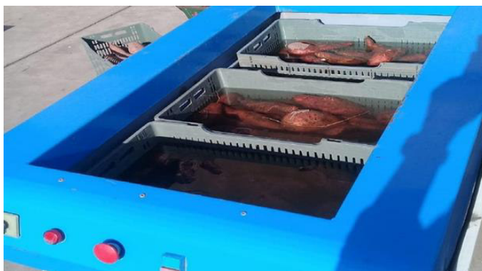
Figura 2. Una de las 3 lavadoras construidas por el proyecto, donde la batata se sumerge y por vibración se va lavando
