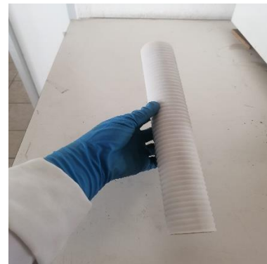
Fotografía 6. Membrana espiral de 10 \mu m empleada en la ultrafiltración.
