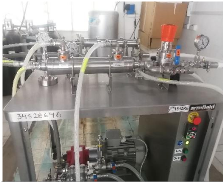
Fotografía 7. Equipo empleado en la clarificación del jugo de naranja
