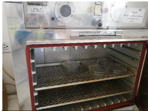
Fotografía 18. Secado de las muestras para la determinación de solidos totales en la estufa
