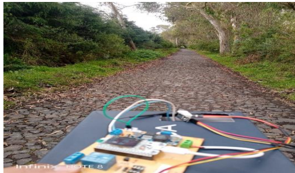
Figura 3.38: Medición de conectividad en zona boscosa
