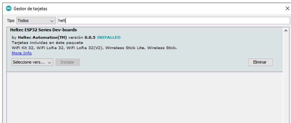
Figura 3.28: Instalación de Heltec ESP32 Series en el gestor de tarjetas
