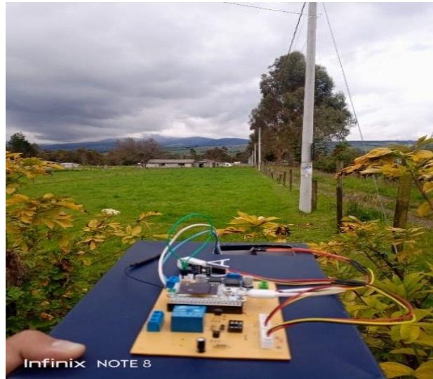
Figura 3.39: Medición de conectividad con interferencia (casas)
