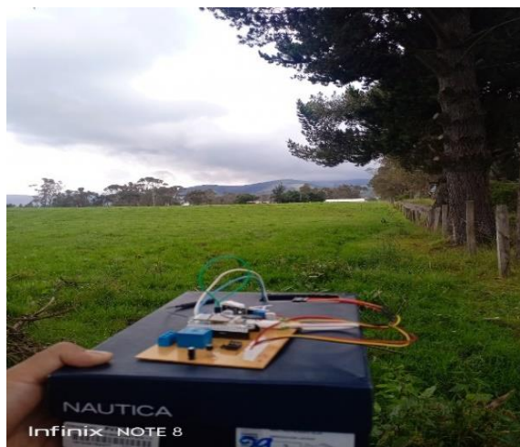
Figura 3.37: Medición de conectividad sin interferencia
