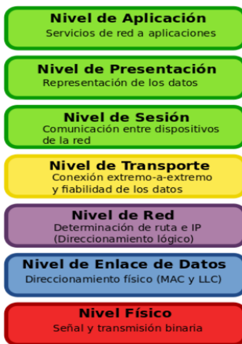
Figura 2.8: Niveles del modelo OSI [21]
