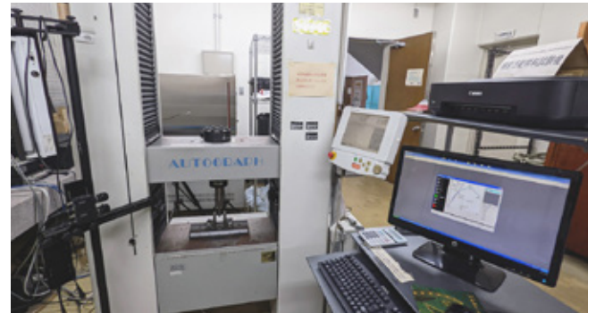
fig.13 万能材料試験機
