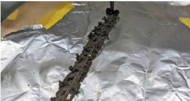
fig.18 材料の吐出が途切れる様子 (材料サンプル②)
