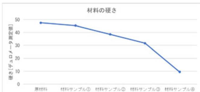
fig.15 各材料サンプルの硬さの測定結果
