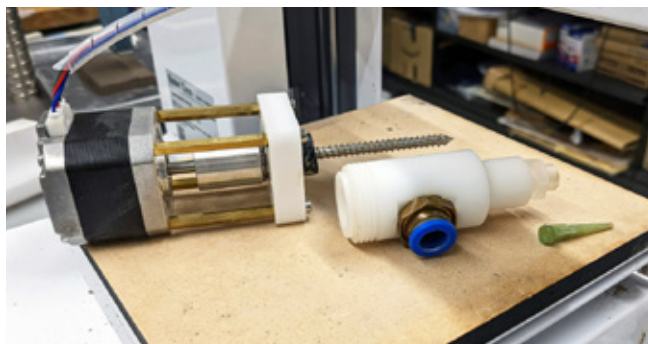
fig.3 エクストルーダーの構造
