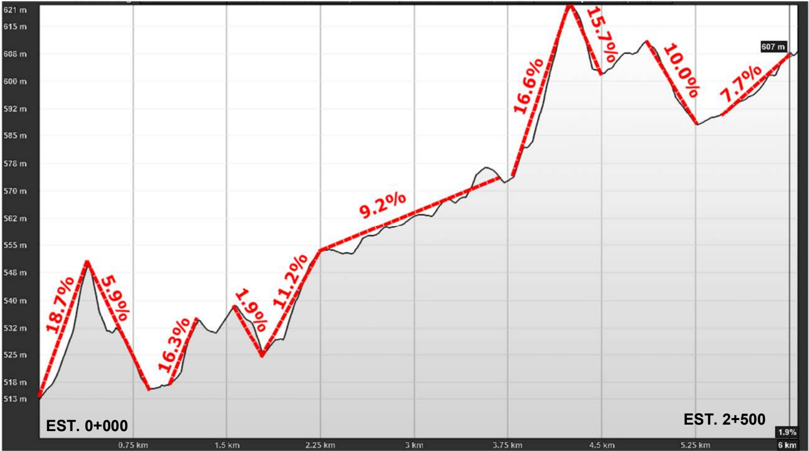
Imagen No. 6. Esquema de perfil longitudinal de elevación Est. 0+000 – Est. 6+000.
