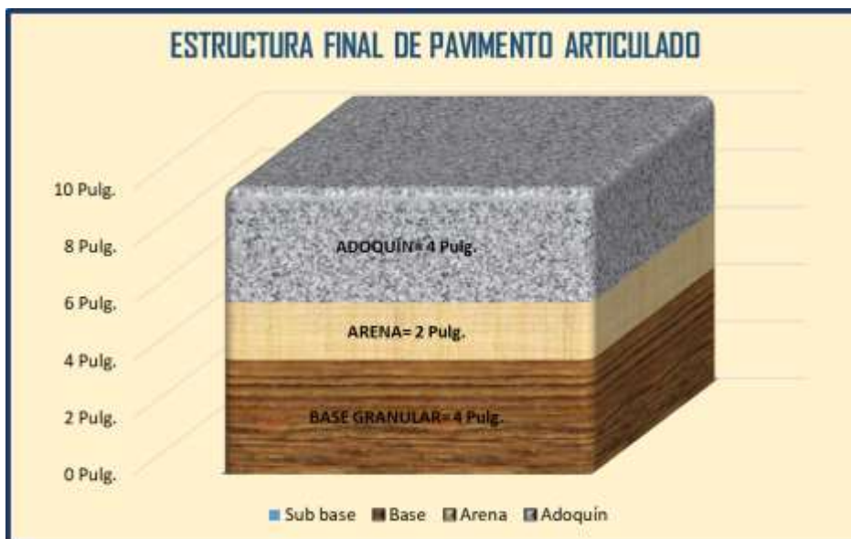
Figura 10: Estructura final del pavimento.
