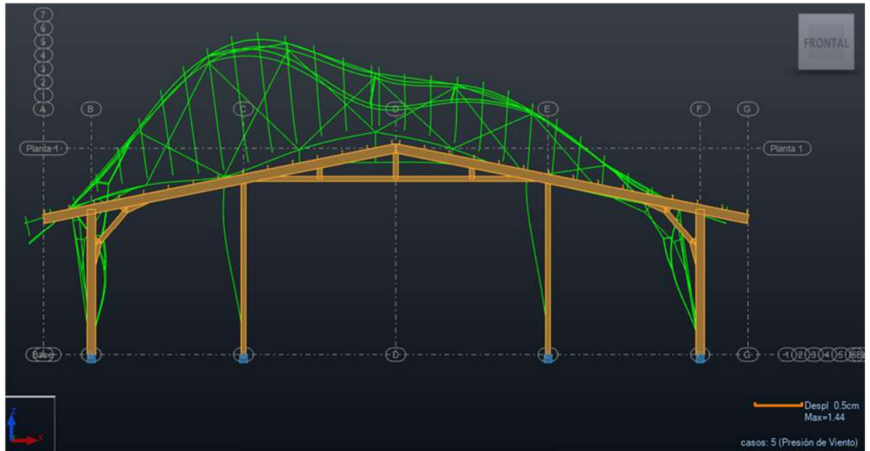
Imagen III. 19. Deformación de la estructura debido a la presión de viento en la nave tipo A. Fuente: ( Propio - Software Robot Structural)
