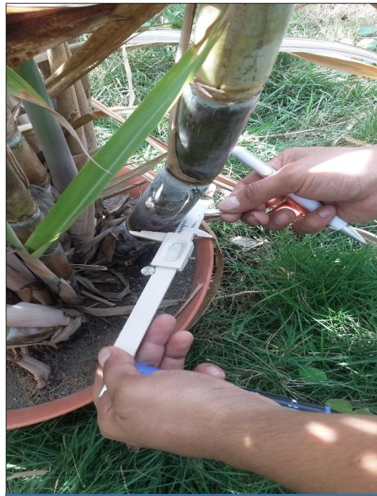
Foto 32: Medición de diámetro en milímetros con vernier o pie de rey
