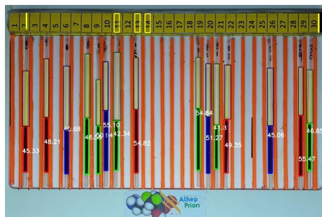
Figura 5. Apreciación de la identificación de capilares y del cálculo de hematocrito realizado por el sistema
