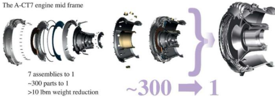
Kuva 10. Osakokoonpanon suunnittelu yhdeksi komponentiksi (Toyserkani et al. 2021, s. 47).
