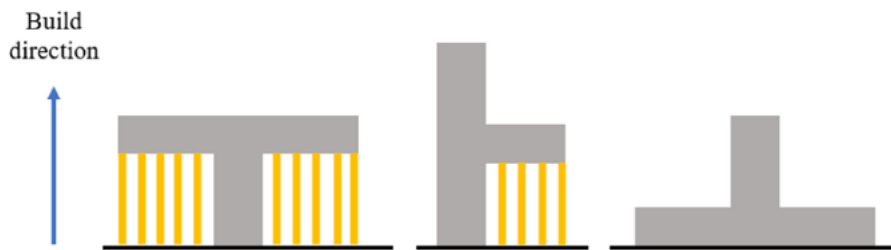
Kuva 9. Tulostusorientaation vaikutus tukirakenteiden määrään (Zhang et al. 2022).
