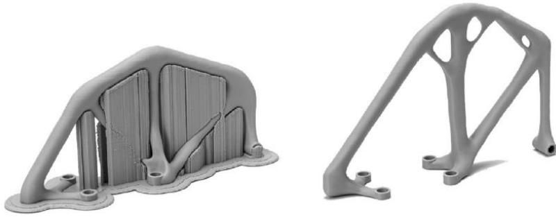
Kuva 8. Tukirakenteita tarvitseva geometria (vasemmalla) ja itseään tukeva geometria (oikealla) (Zhu et al. 2021).
