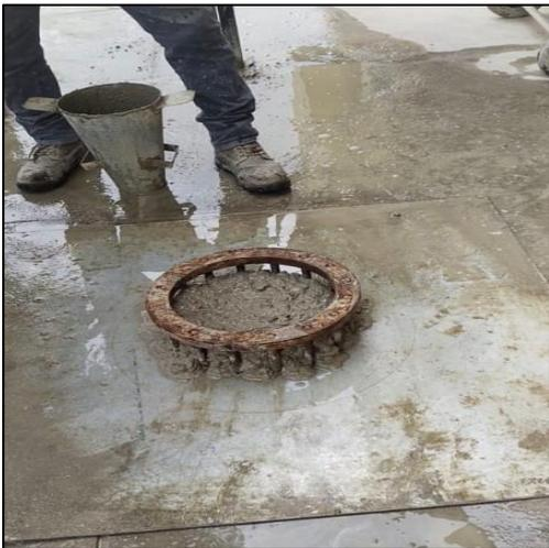
**Figura 23:** Resultados del ensayo practico del Anillo J
