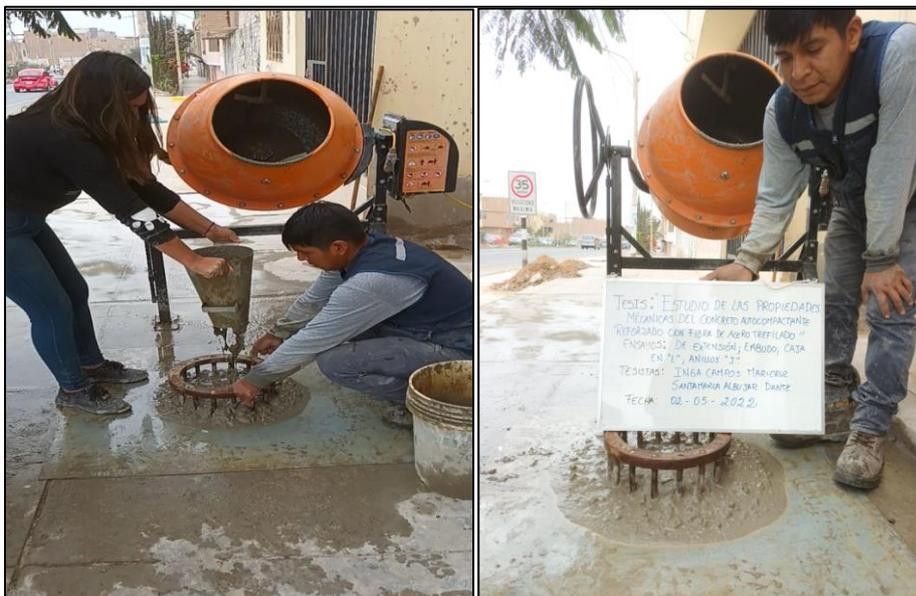
**Figura 19:** Resultados del ensayo practico del Anillo "J"
