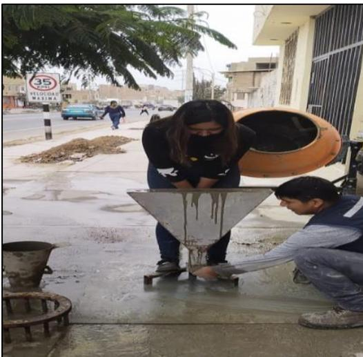
**Figura 21:** Resultados del ensayo práctico del embudo “V”
