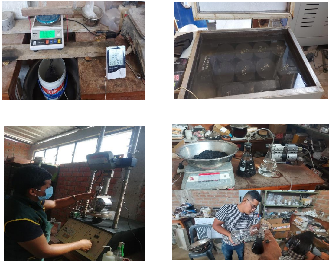
Fig. 15. Procedimiento para ensayos de Estabilidad; Flujo y prueba de vacíos “rice” de las briquetas asfálticas
