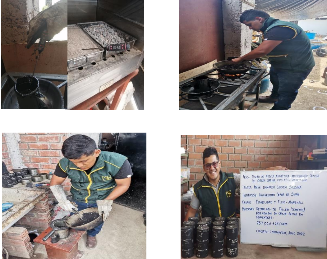
Fig. 14. Procedimiento de elaboración de briquetas asfálticas
