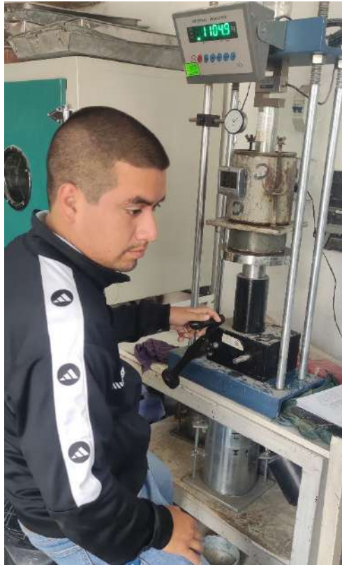
Figura 32.. ENSAYO DE CBR CON MEZCLA DOSIFICADA CON EL LIBRICANTE DE ACEITE DE MOTOR
