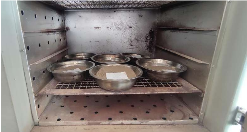
Figura 20. SECADO DE MUESTRAS A 110°C POR 16 HORAS EN EL HORNO PARA ENSAYO DE HUMEDAD
