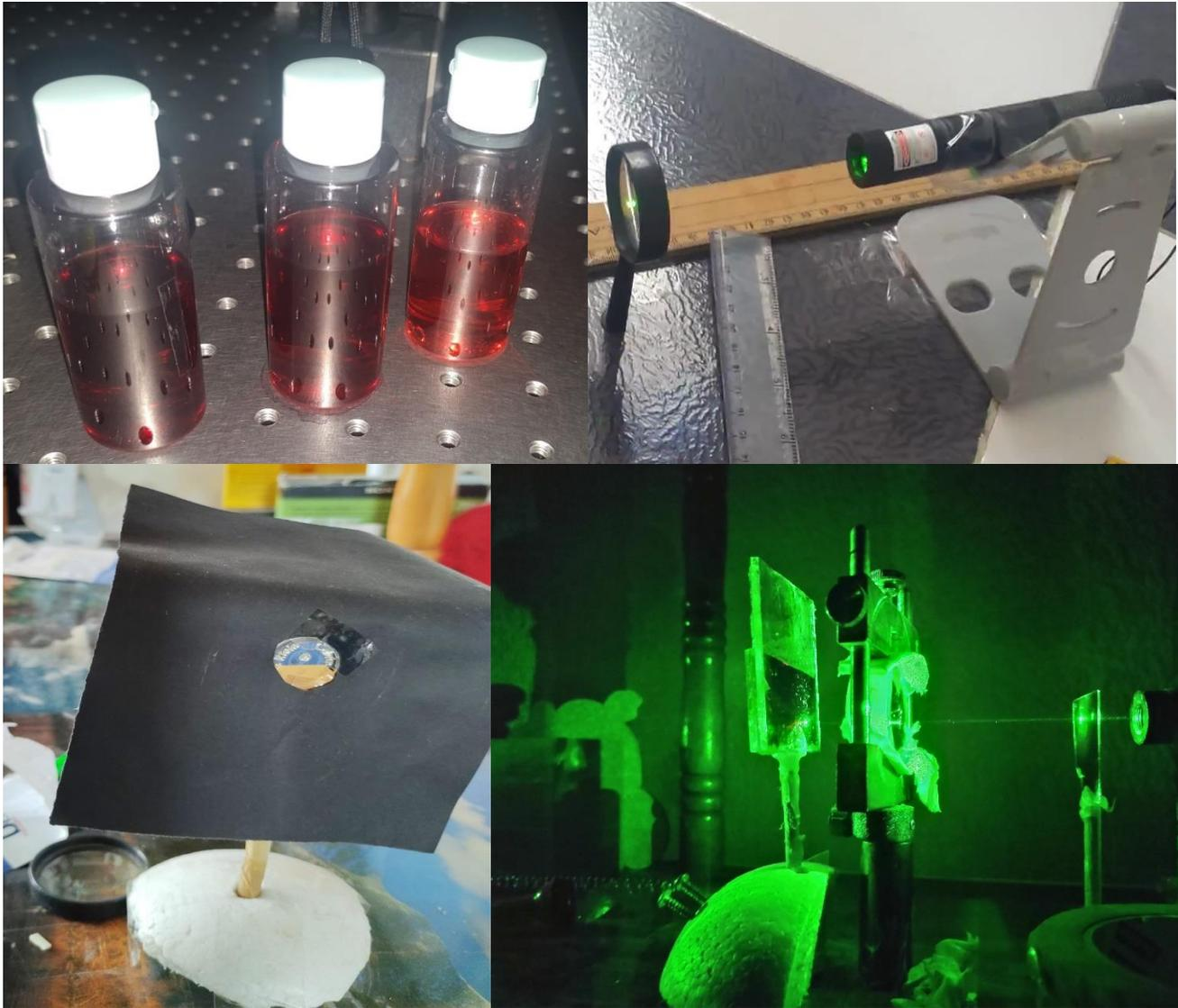
*Figura 3.3. 1 Arreglo experimental casero para la técnica de barrido en Z*
