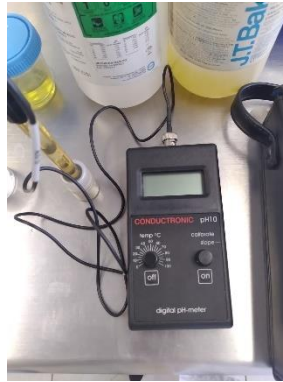
Figura 3. Potenciómetro digital pH-meter. Imagen tomada en laboratorio.
