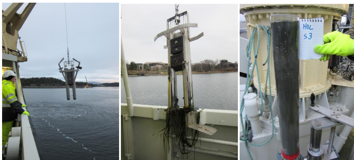
Figur 3. Prøvetaking av sediment ved hjelp av dobbel Geminicorer. Foto: Sigurd Øxnevad.
