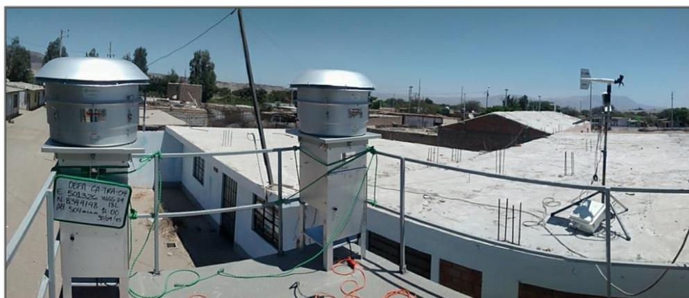
**Descripción:** Calidad de Aire - Equipos muestreadores de partículas (PM-10, PM-2.5) y Estación meteorológica acondicionadas en la unidad móvil del OEFA en el Centro Poblado Poroma Bajo.
