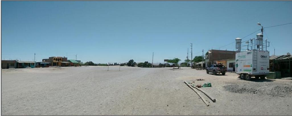
**Descripción:** Calidad de Aire - Equipos muestreadores de partículas (PM-10, PM-2.5) y Estación meteorológica acondicionadas en la unidad móvil del OEFA en el Centro Poblado Pajonal Bajo.
