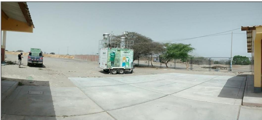
**Descripción:** Calidad de Aire - Equipos muestreadores de partículas (PM-10, PM-2.5) y Estación meteorológica acondicionadas en la unidad móvil del OEFA en el Centro Poblado Chauchilla.
