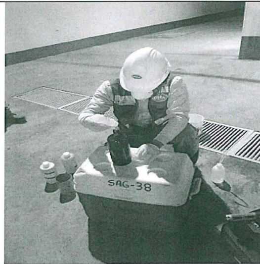
Fotografía N° 03 y 04 Personal realizando la preservación de muestra del efluente
