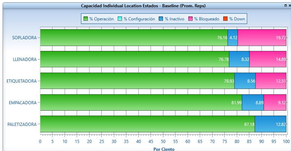
Figura 48: Capacidad individual de las máquinas en la línea de envasado N°8 mejorada
