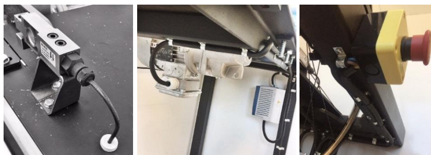
Figur 7.6- Inngående lastcelle, motor og frekvensomformer,
