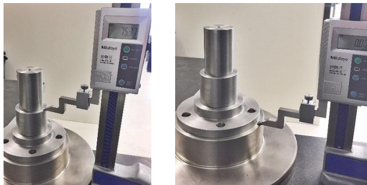
Figur 9.1 - Måling av parallellitet bremsebrakett og hylse
