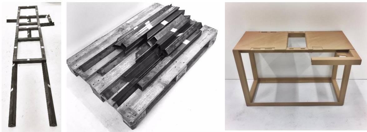
Figur 7.1- Geometrisjekk, frakt og ferdig grunnnet rammekonstruksjon
