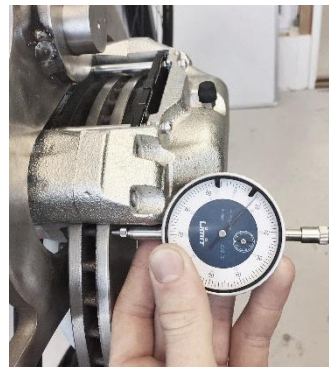
Figur 9.3 - Måling av kast i bremseskive
