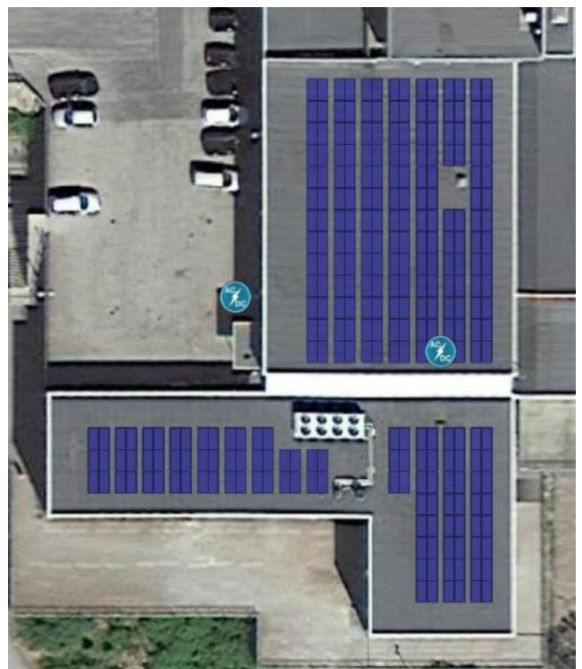
Figur 4: Panelplassering av 128 paneler på taket til Romsås senter.
