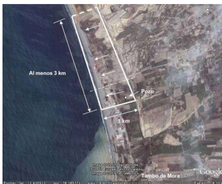
Figura 2.15 Desplazamiento lateral por licuación en Pisco (2007)
