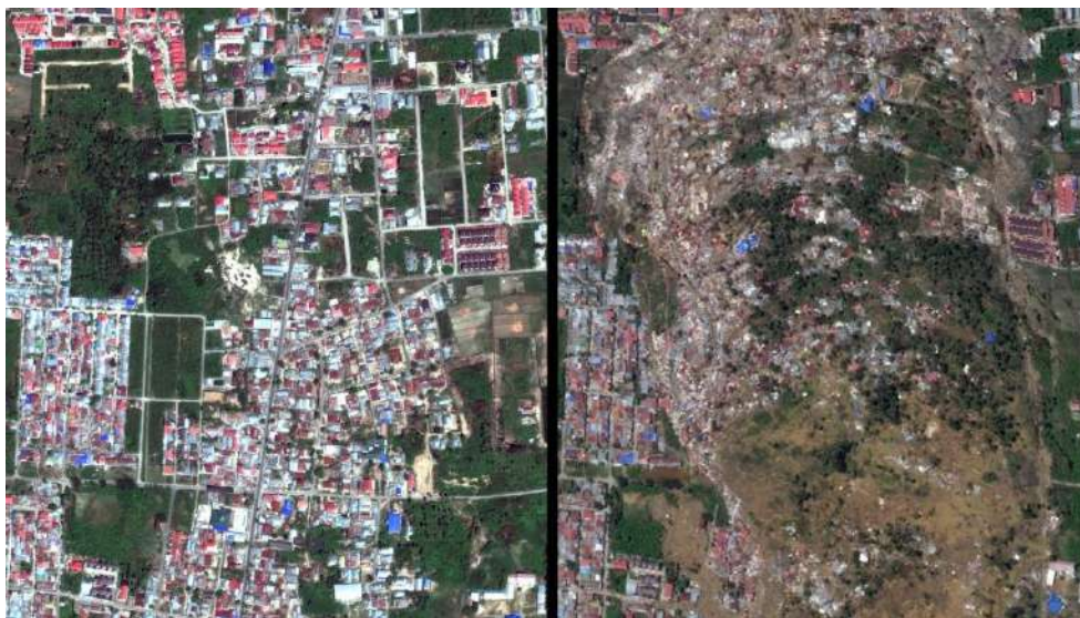
Figura 2.12 Gran desplazamiento de tierra por licuación en Indonesia (2018)
