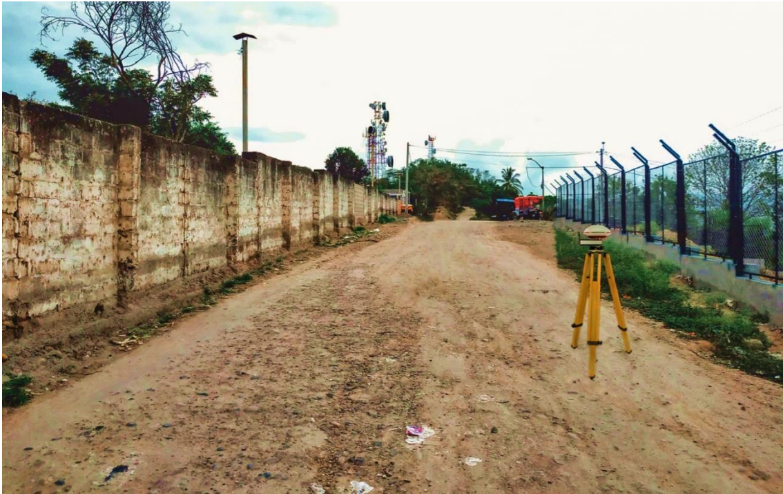
Figura 2. 1 Obtención de BM realizado con GPS geodésico
