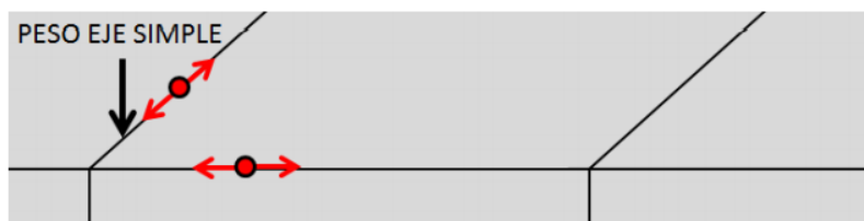
Figura 1. 22 Ubicación del Eje Simple para determinar el agrietamiento de esquina
