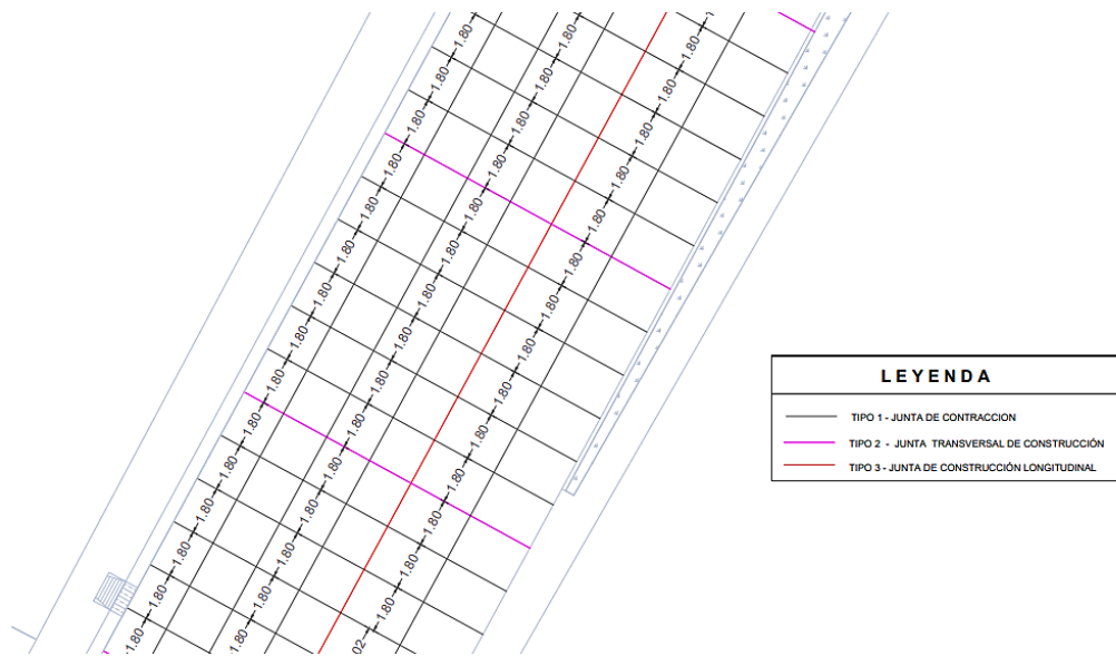
Figura 4. 9 Detalle de Juntas en planta
