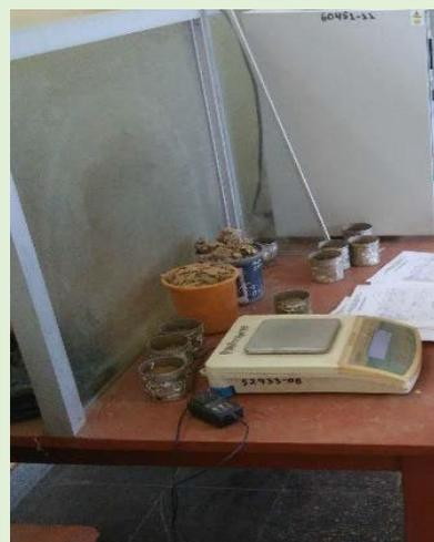
Tomando nota de los pesos de húmedos de las muestras del ensayo CBR
