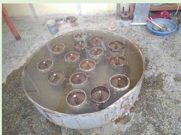
La 15 muestras del ensayo CBR introducidas en el recipiente de
