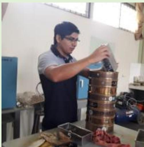
Realizando el ensayo de Granulometría
