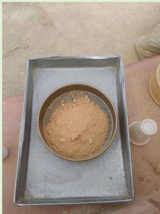
Tamizado del suelo seco por la malla N° 4 para posteriormente hacer los ensayos necesarios en laboratorio
