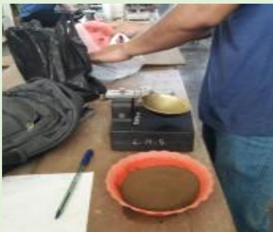
Preparación de la muestra en la Copa de Casa Grande para obtener el limite líquido y Limite Plástico
