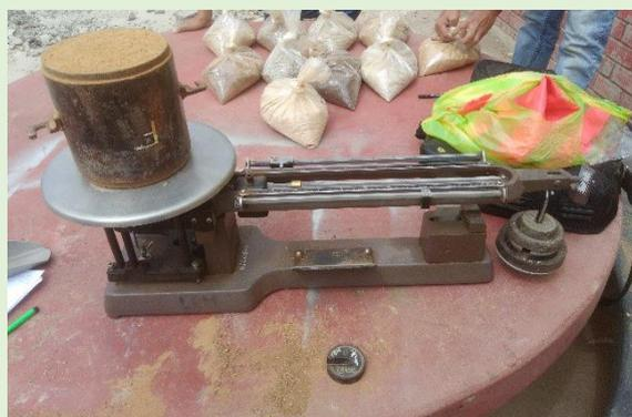
Pesando el molde del ensayo CBR más la muestra compactada
