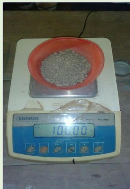
**ENSAYO DE SALES, AGREGANDO AGUA DESTILADA A LOS 100 GRAMOS DE SUELO**
