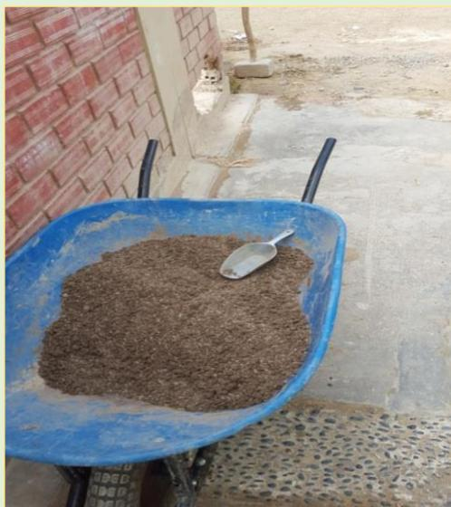
Preparación de la muestra del ensayo CBR para posteriormente ser compactado
