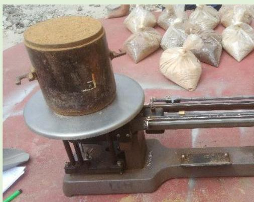
Pesando el molde del ensayo CBR más la muestra compactada
