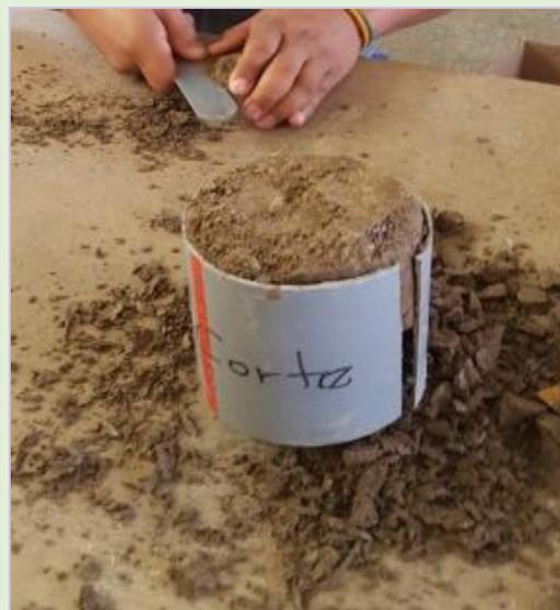
**ENSAYO DE CORTE DIRECTO, TALLADO DE LAS MUESTRAS INALTERADAS EN LOS MOLDES PARA POSTERIORMENTE APLICARLE FUERZAS DE CORTE.**
