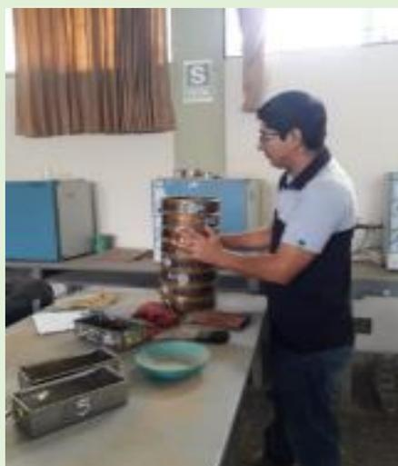
Realizando el ensayo de Granulometría
