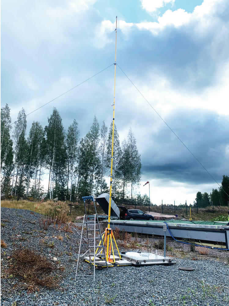
Kuvio 15. Mittausmasto sijoitettuna mittauskohteeseen nähden tuulen alapuolelle. Mastossa on neljä mittauspistettä, joiden korkeudet riippuvat kohteen etäisyydestä.
