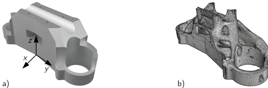
Abbildung 7.7: a) Erweiterter Gestaltungsraum der Motorradgabelbrücke, b) Ergebnis der Topologieoptimierung nach Reparatur und Glättung.
