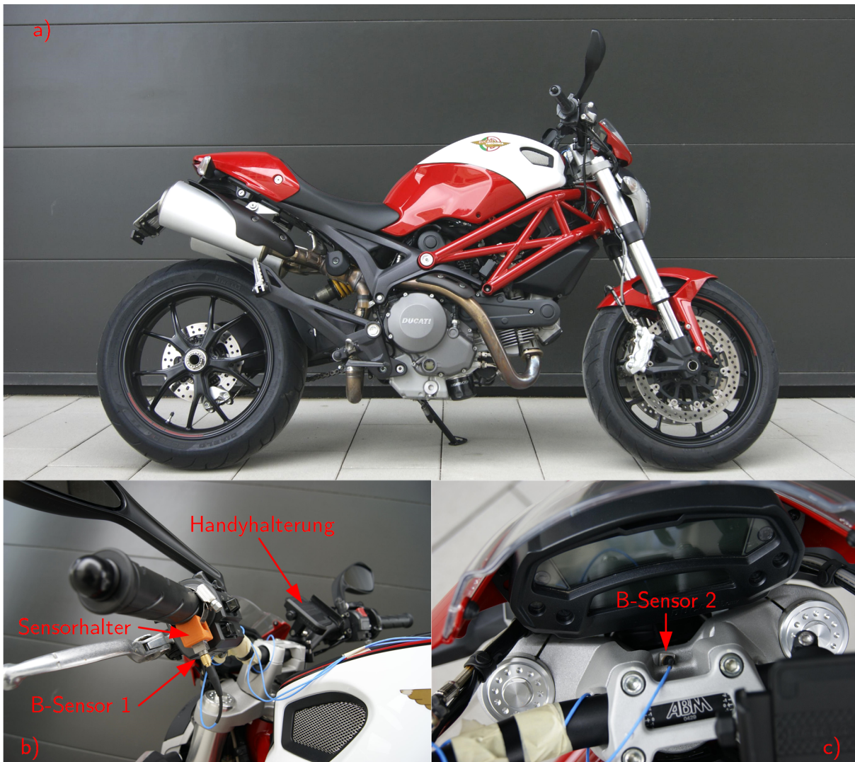
Abbildung 7.2: a) Verwendetes Versuchsfahrzeug Ducati Monster 796 ABS, b) Position des Beschleunigungssensors und dessen Halterung am Griff, c) Position des Beschleunigungssensors an der Motorradgabelbrücke.
