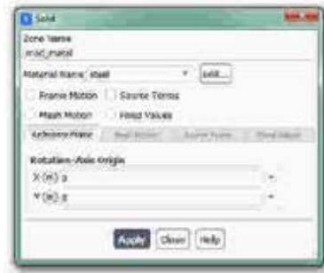
Figura 10.8: Panel de configuración para a asignación de material a unha rexión do dominio.
