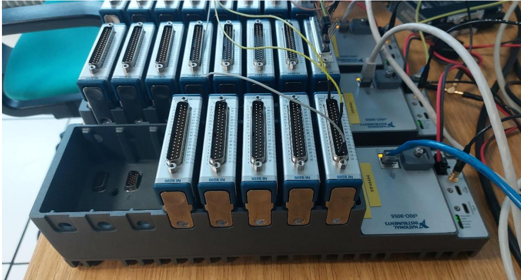
FIGURA 5 - ESEMPIO DI CONNESSIONE MODULI A CONTROLLER
