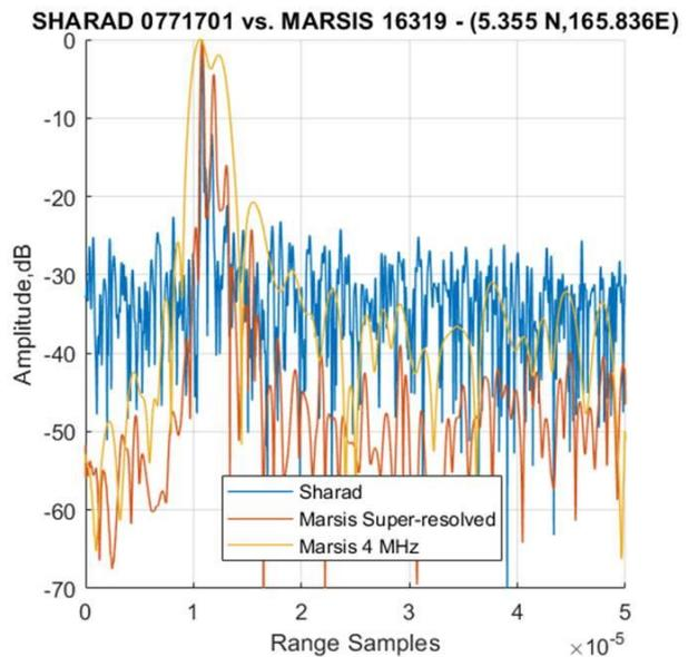
Come atteso, è possibile osservare che la eco sotto-superficiale del dato super-risolto è caratterizzata da una minore attenuazione rispetto al dato di SHARAD. Questo effetto permetterebbe, per mezzo dell'applicazione congiunta dei modelli di inversione ai dati super-risolti di MARSIS e ai dati di SHARAD, di
