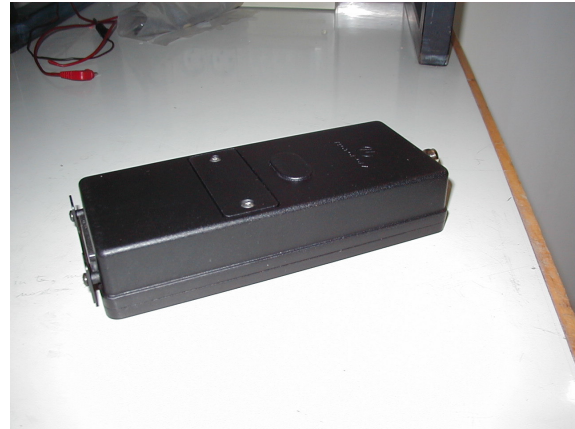
Fig. 1 – Scheda MSITel per gestione TM/TC e modem NAL che costituiscono il modulo di telemetria.
