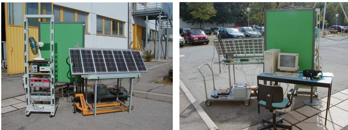
Fig. 6 I test del sistema SPSys integrato con pannello fotovoltaico e batterie
