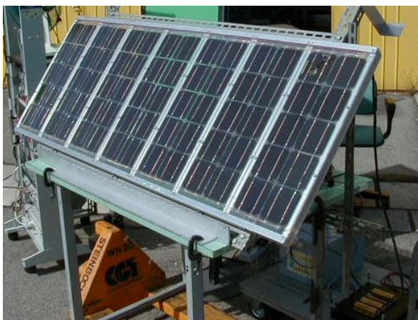
Fig. 2 Sistema Alimentazione a pannelli solari
