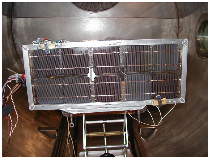
Fig. 1 – Posizionamento del modulo fotovoltaico dentro la camera Termovuoto
