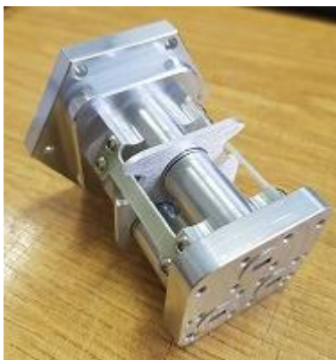
Fig. I.4 Uno dei 19 " bicchierini ", dispositivo che realizza il "gap" termico, esso consente il passaggio caldo-freddo per la connessione in guida d'onda a bassissima attenuazione ma frenando il calore delle seguenti parti: - dai due amplificatori criogenici ai due convertitori di frequenza, in parte calda, - del generatore di rumore (in parte calda) con l'attenuatore raffreddato, entrambi parte del circuito di marca.
