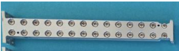
Fig. I.3 Uno dei 19 attenuatori costruiti.
