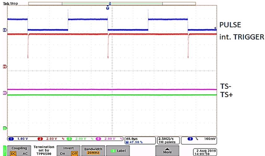
Figura 4. Impulso di test e relativi trigger interni ed esterni.
