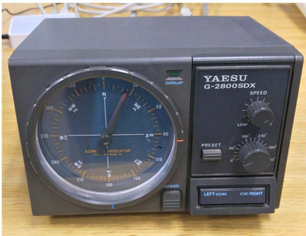
Figura 10: Rotore di antenna, unità interna di controllo
