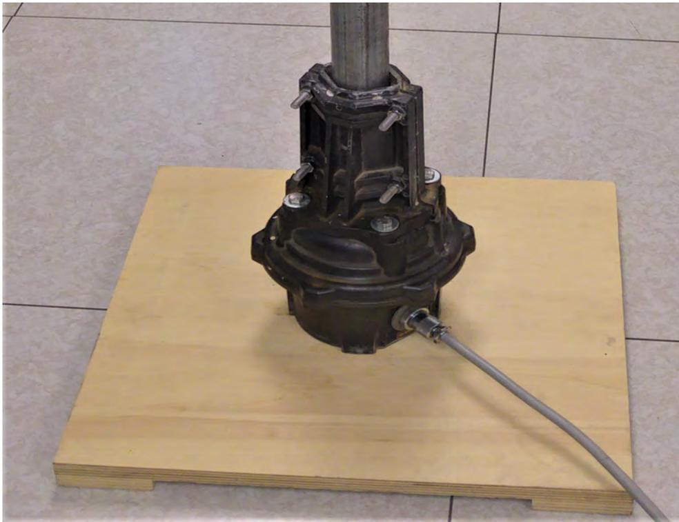
Figura 11: Rotore di antenna, unità esterna di attuazione
