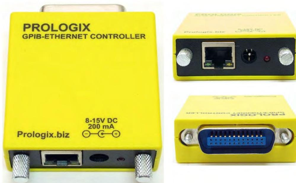
Figura 20: Prologix Controller GPIB-LAN
