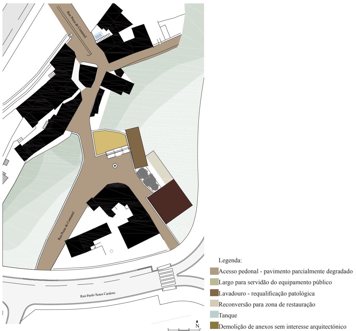
Figura 117 – Planta de Intervenção Manipulado pelo autor
