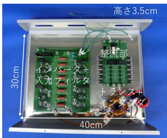
図 2-2 1.5kW コンバータ BBM
