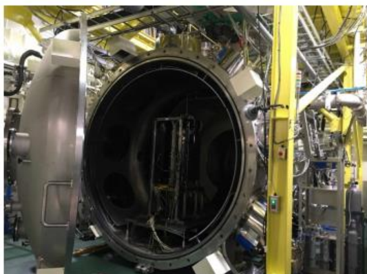
図 3-10 Hall Thruster Development Test (Hall-DT) 真空試験設備 (宇宙科学研究所 JAXA)
