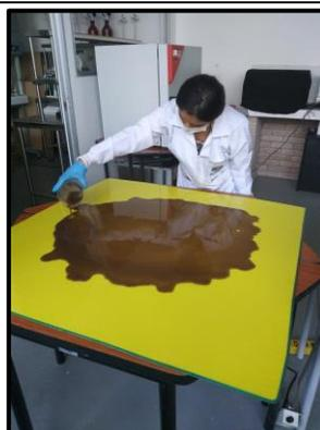
Secado de la muestra a temperatura ambiente por 24 a 48 hora, y finalmente el desmolde
