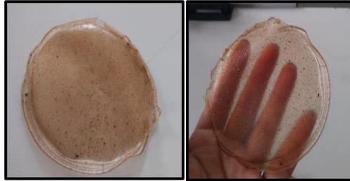
Dentro de los objetivos planteados para el proyecto se realiza el desarrollo de la lámina a se usa en la fabricación de materia desechables usados en la industria de alimentos como pitillos, mezcladores, vasos y platos que tiene un corto tiempo de uso y no se usaran para almacenamiento de alimento es por esto que platean algunos diseño que se presentan en la figura 9.
