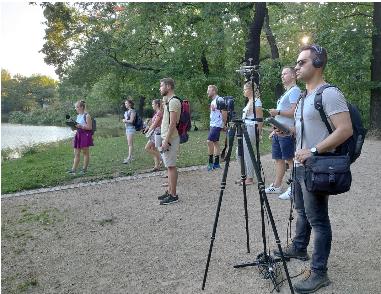
ABBILDUNG 30: DURCHFÜHRUNG EINES SOUNDWALKS IM GROßEN GARTEN AM UNTERSUCHUNGSPUNKT 5. IM VORDERGRUND IST HERR Omid SAMANI MIT DER PSYCHOAKUSTISCHEN MESSTECHNIK ZU SEHEN.
