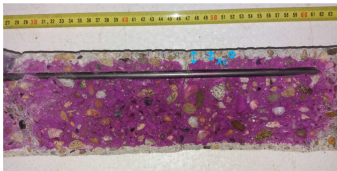
Slika 4 – Merenje dubine karbonatizacije [35]
