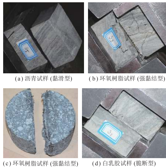
图 1 接触面力学属性测定试验
